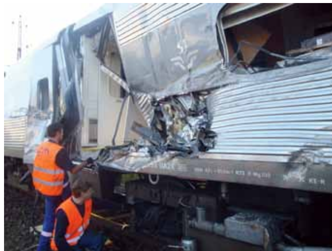
Figur 1. Frontskopan på en grävmaskin trängde in i sidan på ett x2000-tåg. Avståndet ner till banvallen försvårade evakueringen.
